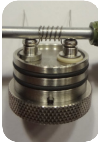
Bild 2: Den Draht, wie dargestellt, unter die beiden Polschrauben legen. Diese anschließend vorsichtig festziehen und die Wickelhilfe entfernen.
